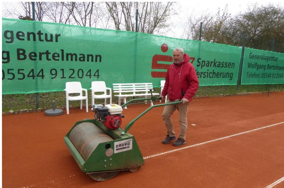
Bahn für Bahn verdichtet die Motorwalze den roten Sand
